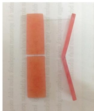
Gambar 1. Resin Akrilik *Heat Cured* dan Termoplastik Nilon Setelah Dilakukan Uji Kekuatan Fleksural.
